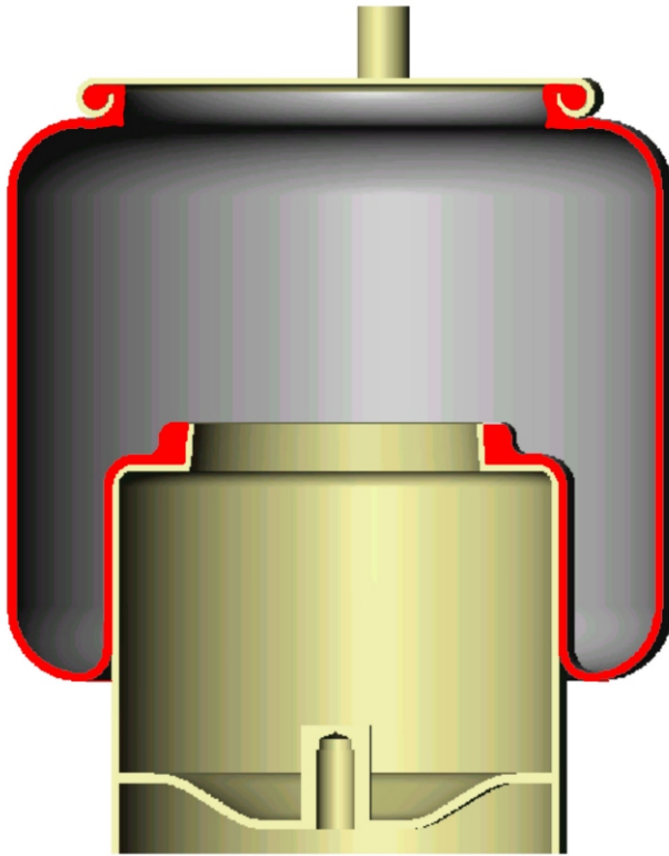
Bild 32: Luftfeder mit Bördelplatte oben und kolbenseitigem Dichtkonus
